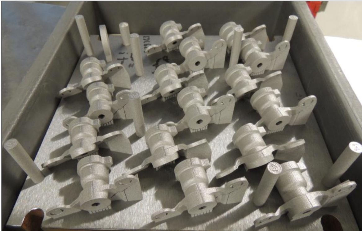
Plattform mit 16 Boroskop-Augen und Zugproben
