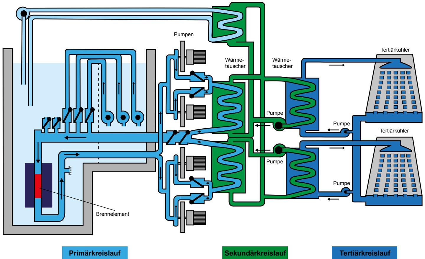
FRM II beträgt die abzuführende Leistung des FRM II nur noch ca. 1,2 MW, bei einem Kernkraftwerk dagegen bis zu 220 MW. Daher benötigt der FRM II nach der Abschaltung zur Abführung der Nachzerfallswärme weder elektrische Energie von außen noch die Verfügbarkeit der vorhandenen Notstromaggregate.
