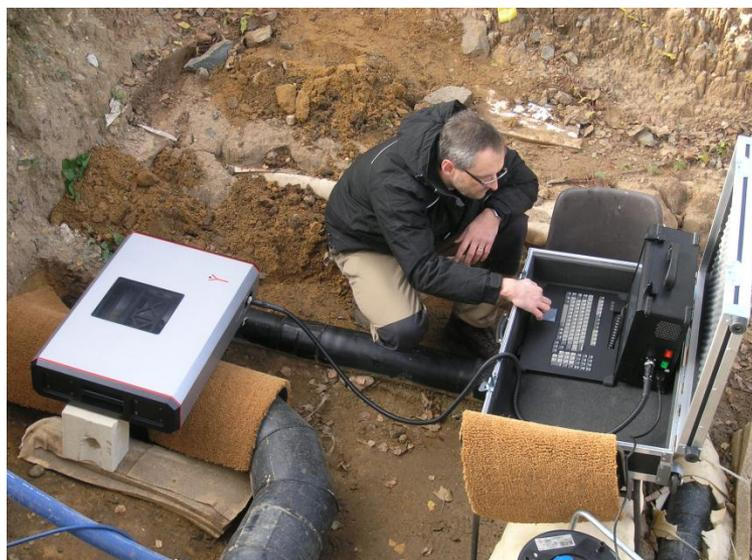
Prüfaufbau THz Feldversuch Chemnitz
