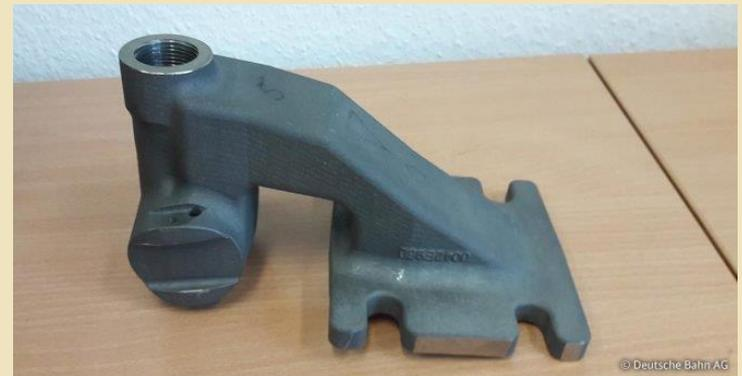
Bremsvorrichtung „Sandtreppe“ Titan; Laser-Strahlschmelz-Verfahren
