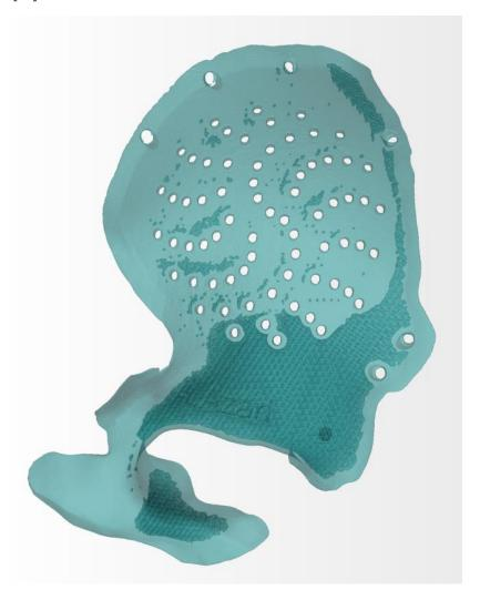
Eingebrachte Gitterstruktur mit Pulverrückständen kontaminiert
