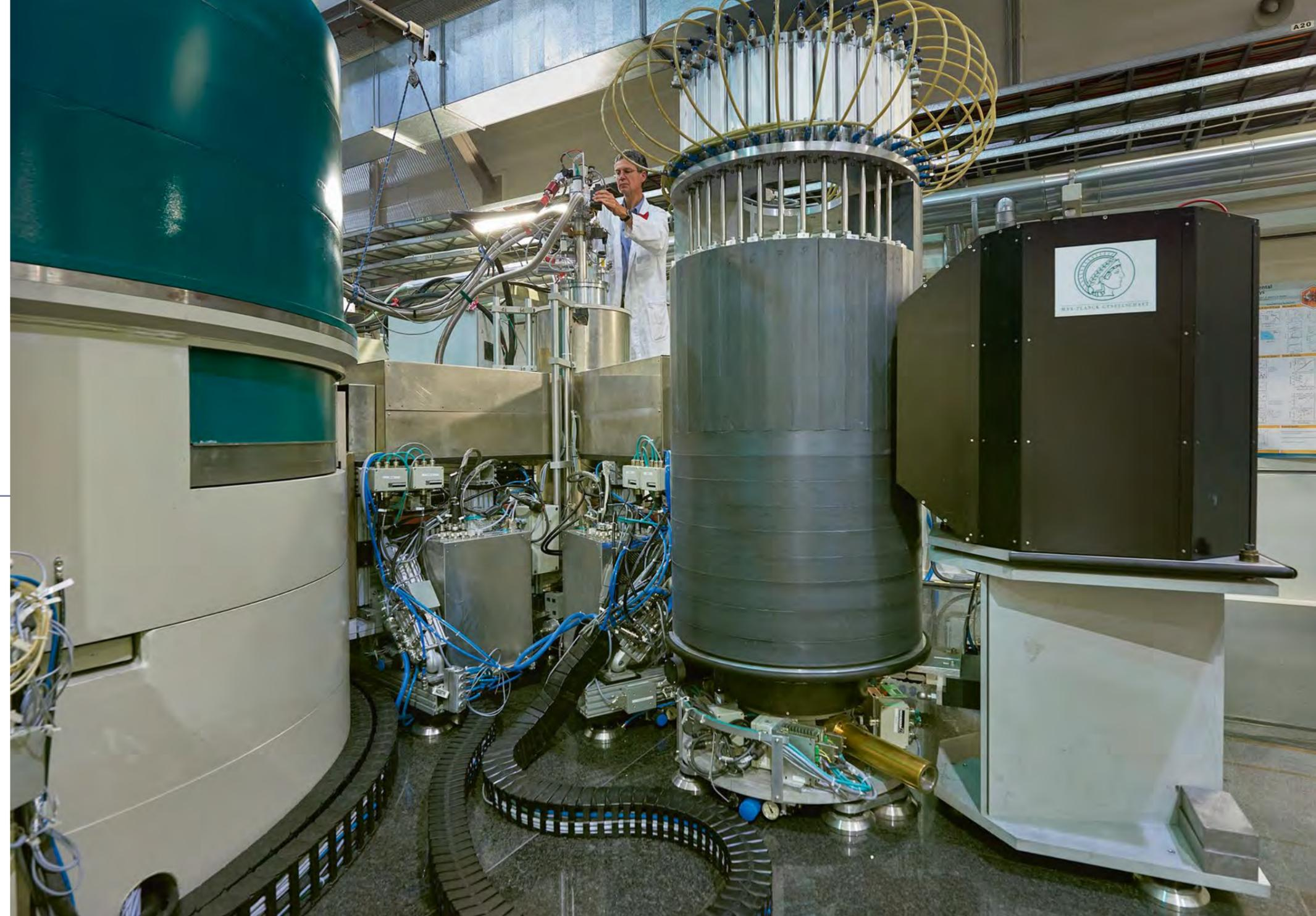
**D**ie beiden Instrumentwissenschaftler Dr. Michael Hofmann (l.) und Dr. Weimin Gan bereiten ein Experiment am Instrument STRESS-SPEC (Materialforschungsdiffraktometer) vor. Das Diffraktometer ist v. a. für Industriepartner von Interesse, die hier Eigenspannungen in Materialien messen.
