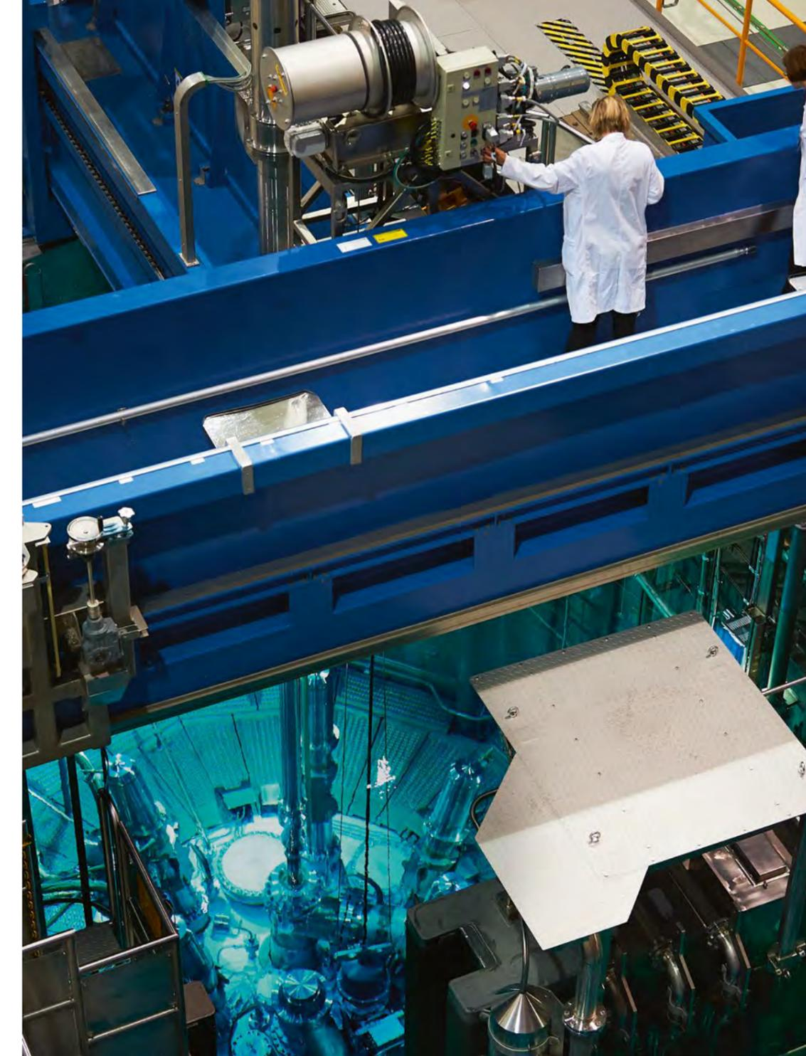
**E**in technischer Mitarbeiter bei der Handhabung der Siliziumdotierungsanlage.
