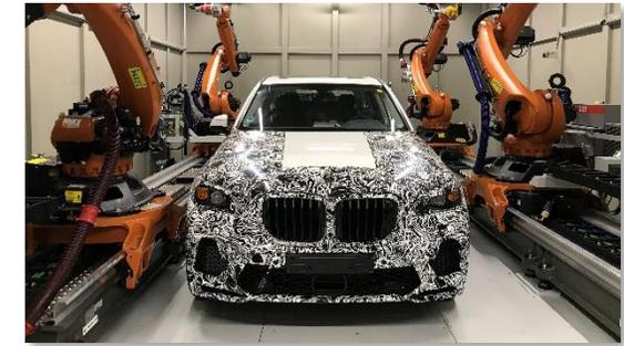
Scans von Crashversuchsfahrzeugen bzw. Bauteilen ohne Demontage.
