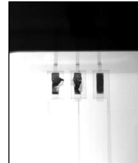
Überprüfung Verlotung Antennenübergang in der Heckscheibe (links konventionelle Röntgen CT Anlage, Rechts Roboter CT). Für konventionelle CT Anlagengröße und Erreichbarkeit schwierig.
