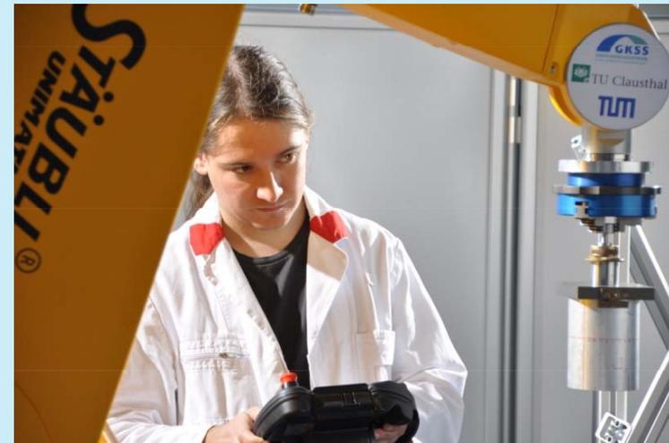
Wissenschaftler beim Messen mit einem Roboter am Eigenspannungsdiffraktometer Stress-Spec der Forschungs-Neutronenquelle Heinz Maier-Leibnitz der TU München
