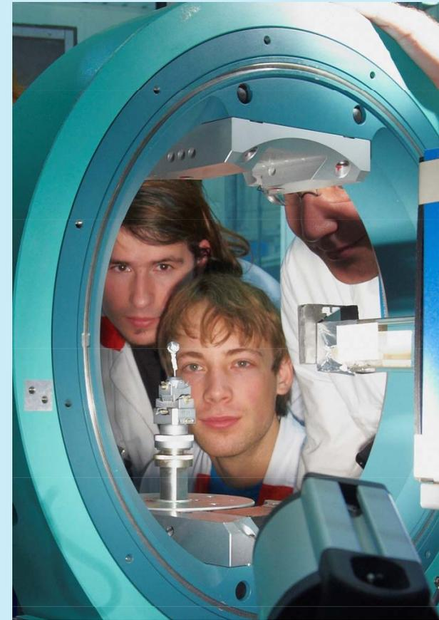
Studenten und Wissenschaftler am Einkristalldiffraktometer RESI der Forschungs-Neutronenquelle beim Vorbereiten einer Messung mit Neutronen.
