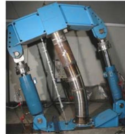
Für die Übertragbarkeit von Ergebnissen auf Gesamtkomponenten sind genaue Kenntnisse des vorliegenden Eigenspannungszustandes über der gesamten Wanddicke des Rohres unabdingbar.
